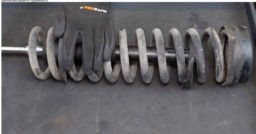
20 Сложете компресора за пружини на новата пружина.
