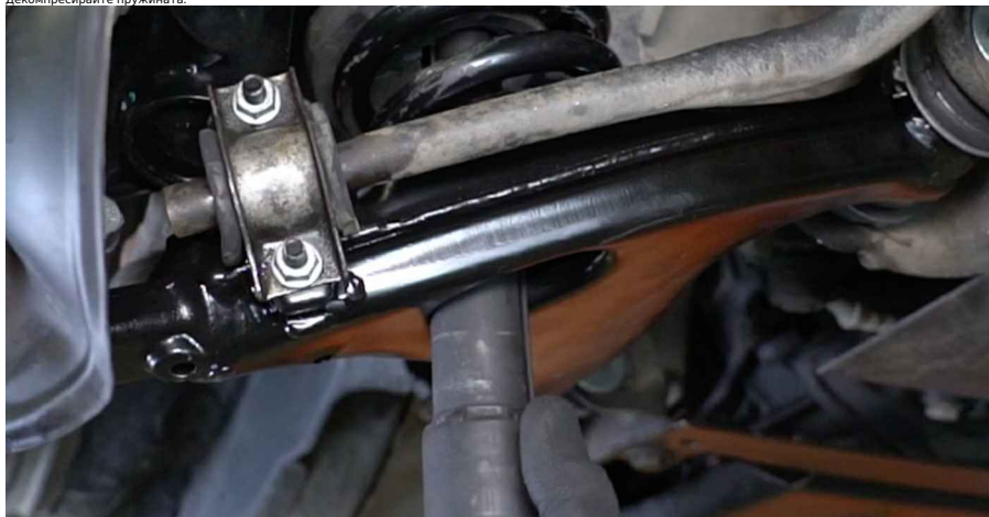
32 Отстранете скобата за компресиране на пружини.
