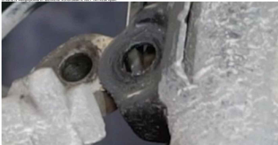
14 Почистете крепежните елементи на скобите на тампоните на стабилизатора. Използвайте телена четка. Използвайте спрей WD-40.
