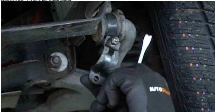
18 Премахнете спиралната пружина, заедно със скобата за компресиране на пружини.
