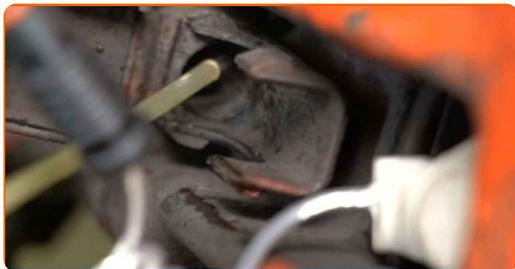
**24** Закрепете конектора на сензора за износване на спирачната накладка.
