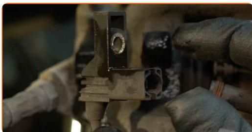
**12** Откачете фиксиращата пружина на спирачния апарат. Използвайте лост тип кози крак.
