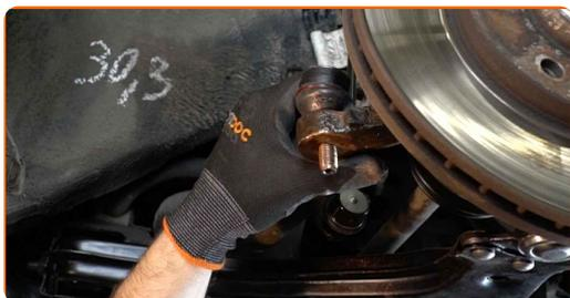
**16** Затегнете закрепващата гайка, която свързва кормилния накрайник с шенкела. Използвайте тръбен ключ №19. Използвайте динамометричен ключ. Затегнете я с усилие от 50 Nm.
