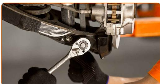
**10** Развийте крепежния елемент, който свързва стабилизатора с биалетката. Използвайте комбиниран гаечен ключ №17. Използвайте комбиниран гаечен ключ №19.
