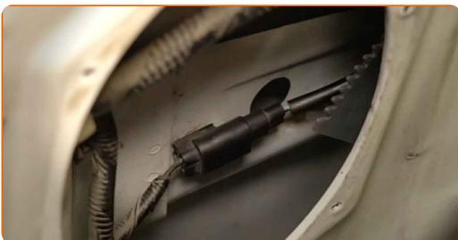
**24** Монтирайте крепежния болт на направляващата релса на стъклото.
