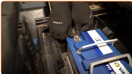
**14** Завийте крепежния елемент на отрицателната клема на акумулатора. Използвайте гаечен накрайник 10 мм. Използвайте тресчотка.
