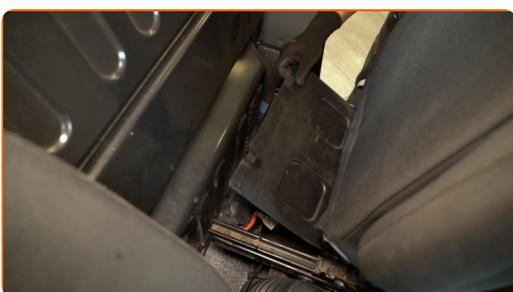
4 Развийте крепежния елемент на отрицателната клемма на акумулатора. Използвайте гаечен накрайник 10 мм. Използвайте тресчотка.
