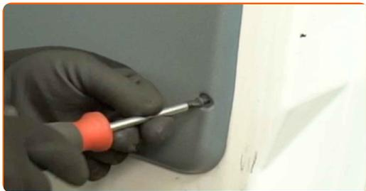
**5** Откачете панела на вратата. Използвайте пластмасов инструмент за демонтаж на тапицерна.
