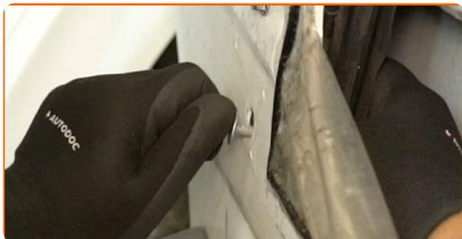
**17** Развийте крепежните елементи на механизма на стъклоповдигача. Използвайте гаечен накрайник 10 мм. Използвайте тресчотен ключ.
