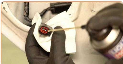
**34** Обработете конектора на бутона за ел. стъклата. Използвайте контактен спрей за електроника.
