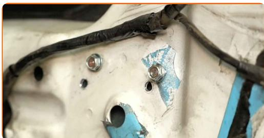
**22** Затегнете крепежните елементи на механизма на стъклоповдигача. Използвайте гаечен накрайник 10 мм. Използвайте динамометричен ключ. Сила на затягане: 8 N·m.
