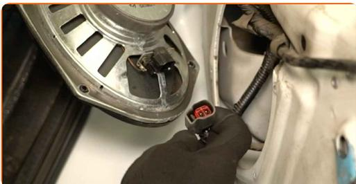
11 Откачете конектора от мотора на стъклоповдигача.
