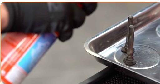
**21** Обработете направляващите палци на спирачния апарат. Използвайте смазката за направляващи палци на спирачен апарат.
