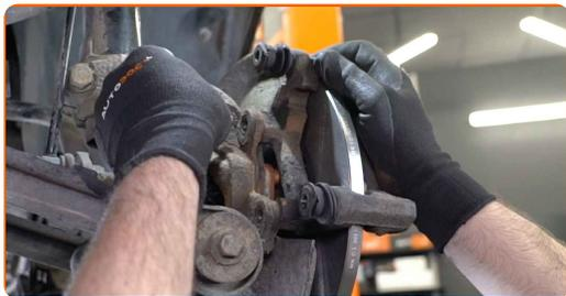
**24** Стегнете болтовете на планката на спирачния апарат. Използвайте тръбен ключ №13. Използвайте динамометричен ключ. Затегнете я с усилие от 65 Nm.
