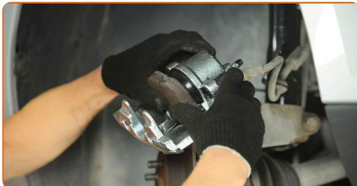
Смяна на: спирачен апарат – FORD Kuga Mk2 (DM2). Експертите на AUTODOC препоръчват:
