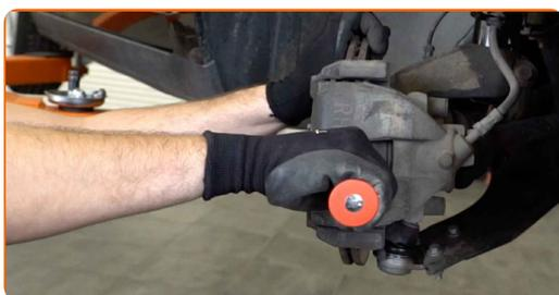
8 Почистете болтовете на скобата на спирачния апарат. Използвайте телена четка. Обработете болтовете на скобата на спирачния апарат. Използвайте спрей WD-40.
