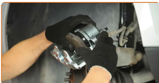
Смяна на: спирачен апарат – FORD FOCUS III. Експертите на AUTODOC препоръчват:
