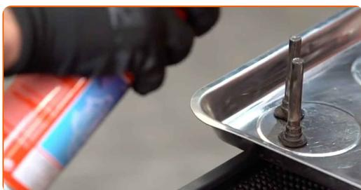
**27** Обработете направляващите палци на спирачния апарат. Използвайте смазката за направляващи палци на спирачен апарат.
