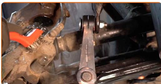
Смяна на: спирачен апарат – FORD FOCUS III. AUTODOC препоръчва:
