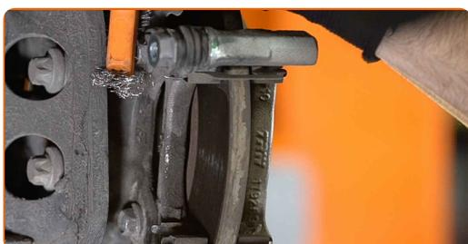
**12** Развийте крепежните елементи на планката на спирачния апарат. Използвайте комбиниран гаечен ключ №13.
