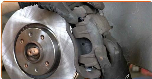
**80** Стегнете болтовете на планката на спирачния апарат. Използвайте Torx T55. Използвайте динамометричен ключ. Затегнете я с усилие от 105 Nm.
