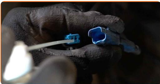
**67** Закрепете конектора на ABS сензора.
