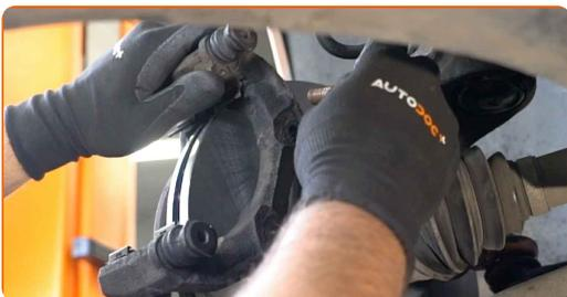
**25** Стегнете болтовете на планката на спирачния апарат. Използвайте Torx T55. Използвайте динамометричен ключ. Затегнете я с усилие от 105 Nm.
