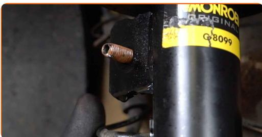
**12** Затегнете крепежния елемент, който свързва стабилизатора с макферсона. Използвайте тръбен ключ №17. Използвайте динамометричен ключ. Затегнете я с усилие от 43 Nm.
