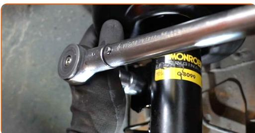
**13** Затегнете крепежния елемент, който свързва стабилизатора с биалетката. Използвайте тръбен ключ №17. Използвайте динамометричен ключ. Затегнете я с усилие от 43 Nm.
