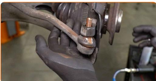
**59** Затегнете закрепващата гайка, която свързва кормилния накрайник с шенкела. Използвайте комбиниран гаечен ключ № 18. Използвайте динамометричен ключ. Затегнете я с усилие от 75 Nm.
