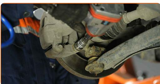
**65** Обработете крепежния елемент свързващ кормилния накрайник с шенкела. Обработете крепежните елементи на шенкела. Обработете болтовете на скобата на спирачния апарат. Обработете крепежните елементи свързващи носача към шенкела. Използвайте медна грес.
