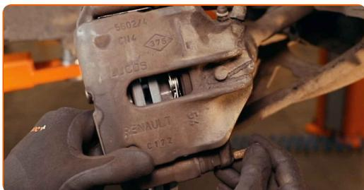
**28** Затегнете крепежните елементи на спирачния апарат. Използвайте комбиниран гаечен ключ № 17. Използвайте тръбен ключ №13. Използвайте динамометричен ключ. Затегнете я с усилие от 32 Nm.
