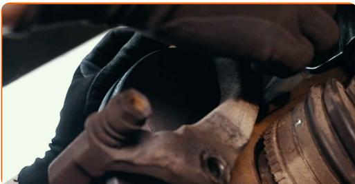
**23** Стегнете болтовете на планката на спирачния апарат. Използвайте тръбен ключ №18. Използвайте динамометричен ключ. Затегнете я с усилие от 100 Nm.
