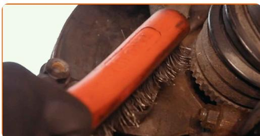
**12** Развийте крепежните елементи на планката на спирачния апарат. Използвайте тръбен ключ №18. Използвайте тресчотен ключ.
