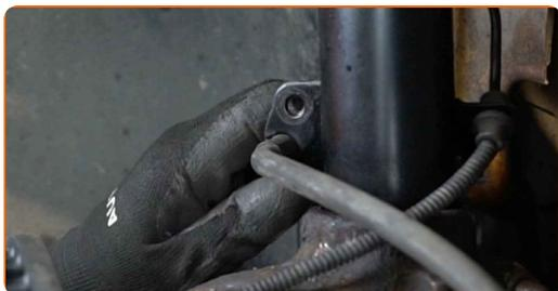
**82** Стегнете закрепването на скобата на спирачния маркуч към амортизатора. Използвайте тръбен ключ №13. Използвайте динамометричен ключ. Затегнете я с усилие от 10 Nm.
