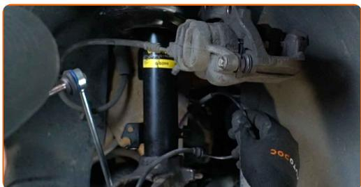
**66** Обработете конектора на ABS сензора. Използвайте диелектрична грес.
