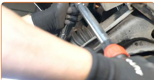
**81** Захванете закрепващата конзола на спирачния маркуч.
