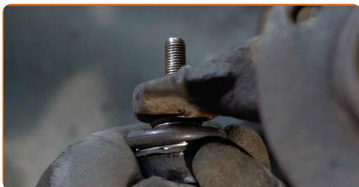
**72** Завийте крепежната гайка, която свързва кормилния накрайник с шенкела. Използвайте тръбен ключ №17. Използвайте тресчотен ключ.
