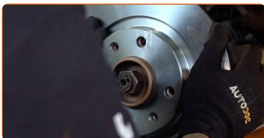
**20** Затегнете фиксиращите болтове на спирачния диск. Използвайте Torx T30. Използвайте динамометричен ключ. Затегнете я с усилие от 9 Nm.
