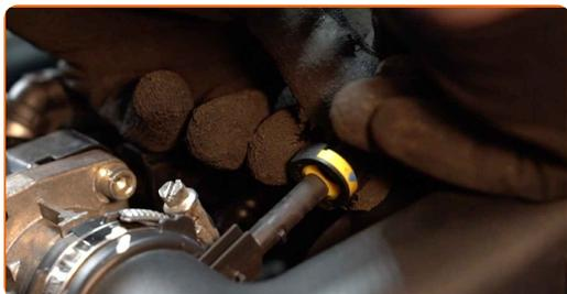
**4** Развийте скобата, която захваща въздушния филтър на двигателя към корпуса на дроселната клапа. Използвайте тръбен ключ №7.
