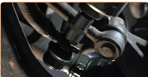
**13** Затегнете крепежния елемент, който свързва стабилизатора с биалетката. Използвайте тръбен ключ №17. Използвайте динамометричен ключ. Затегнете я с усилие от 40 Nm.
