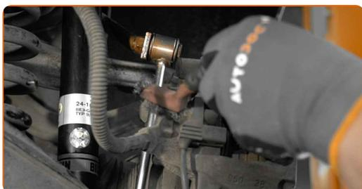
**9** Развийте крепежните елементи на кабелите на сензора за износване на спирачната накладка. Използвайте Torx E10. Използвайте тресчотен ключ.
