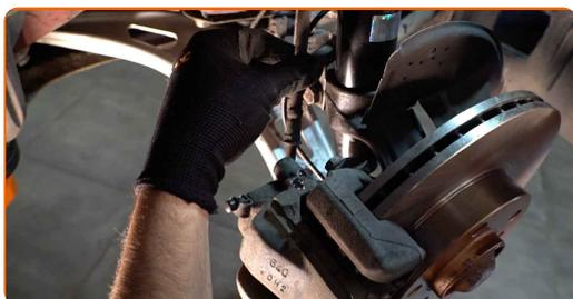
**13** Завийте новия спирачен маркуч на спирачния апарат.
