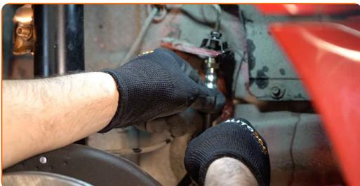
**16** Затегнете крепежния елемент свързващ спирачната тръба със спирачния апарат. Използвайте комбиниран гаечен ключ № 14. Използвайте динамометричен ключ. Затегнете я с усилие от 22 Nm.
