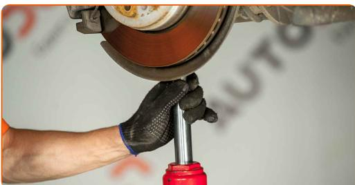
**22** Затегнете предният крепежен елемент свързващ носача с подрамката. Използвайте комбиниран гаечен ключ № 18 (2 броя). Използвайте динамометричен ключ. Затегнете я с усилие от 100 Nm.
