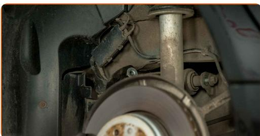
**12** Развийте крепежния елемент свързващ носача със задния шенкел. Използвайте комбиниран гаечен ключ № 21. Използвайте тръбен ключ №10. Използвайте тресчотен ключ.
