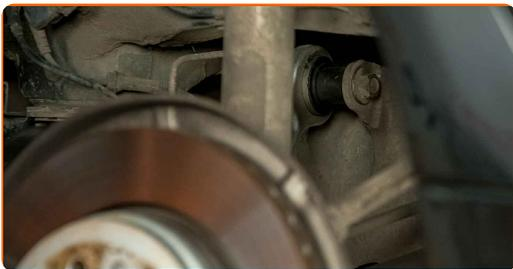
**20** Завийте закрепването в предната част на носача. Използвайте комбиниран гаечен ключ № 18 (2 броя).
