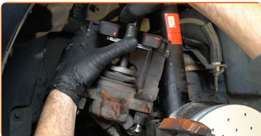
**19** Обработете спирачните накладки в областта, където повърхността им влиза в контакт със скобата на спирачния апарат. Използвайте грес против скърцане за спирачки.
