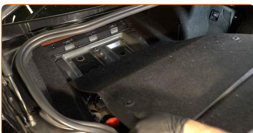
**4** Развийте крепежния елемент на централния пластмасов защитен панел. Използвайте кръстата отвертка. Използвайте клещи за демонтаж на щипки. Използвайте Torx T40. Използвайте тресчотен ключ.
