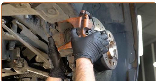
**62** Стегнете болтовете на планката на спирачния апарат. Използвайте тръбен ключ №18. Използвайте динамометричен ключ. Затегнете я с усилие от 110 Nm.
