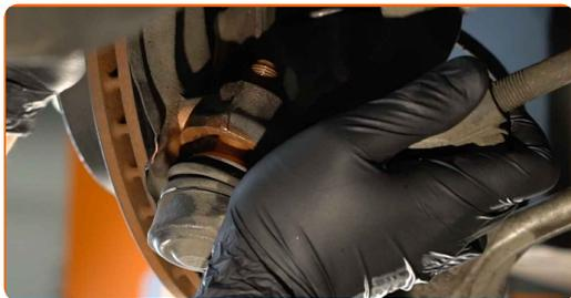
**60** Завийте крепежната гайка, която свързва кормилния накрайник с шенкела. Използвайте тръбен ключ №21. Използвайте тресчотен ключ.
