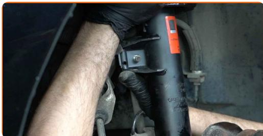
**73** Затегнете крепежния елемент, който свързва стабилизатора с макферсона. Използвайте комбиниран гаечен ключ № 18. Използвайте тръбен ключ №15. Използвайте динамометричен ключ. Затегнете я с усилие от 58 Nm.
