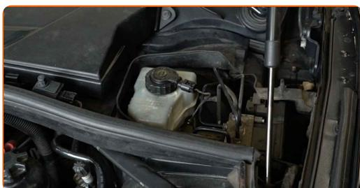
**4** Развийте капачката на резервоара за спирачна течност.
