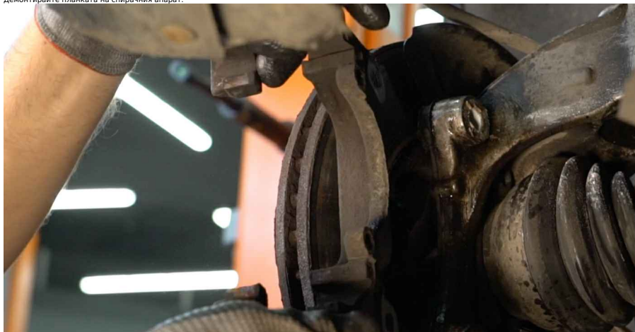
16 Почистете крепежните елементи на спирачния диск. Използвайте телена четка. Използвайте спрей WD-40.
