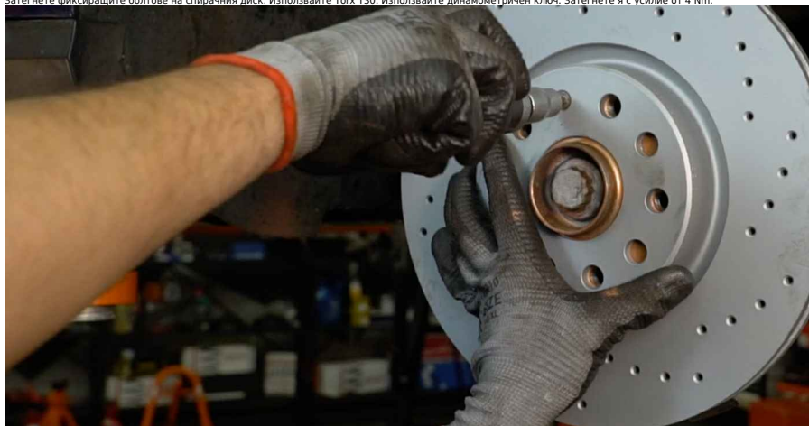
21 Затегнете фиксиращите болтове на спирачния диск. Използвайте Torx T30. Използвайте динамометричен ключ. Затегнете я с усилие от 4 Nm.
