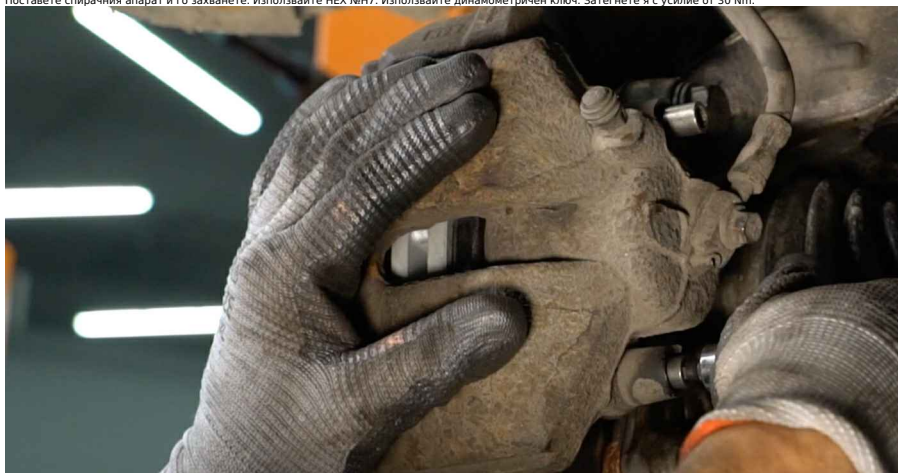
29 Монтирайте маншона на направляващите щифтове на спирачния апарат.
