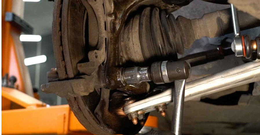
15 Демонтирайте планката на спирачния апарат.
