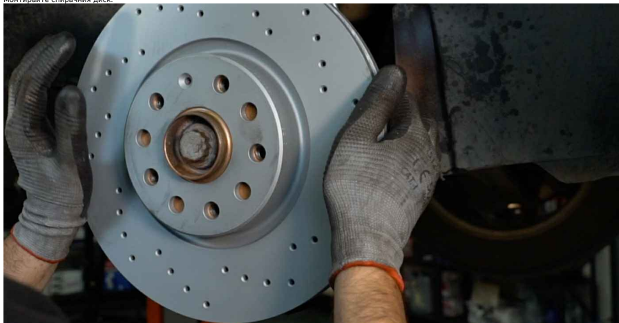
21 Затегнете фиксиращите болтове на спирачния диск. Използвайте Torx T30. Използвайте динамометричен ключ. Затегнете я с усилие от 4 Nm.
