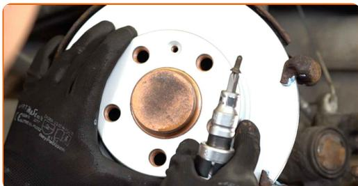
**18** Затегнете фиксиращите болтове на спирачния диск. Използвайте Torx T30. Използвайте динамометричен ключ. Затегнете я с усилие от 4 Nm.
