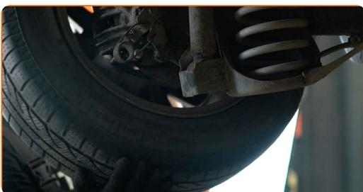
**7** Отсъединете куплунга от датчика на ABS. Отсъединете куплунга на датчика за износване на спирачните накладки. Свалете конектора на ABS сензора. Свалете конектора на датчика за износване на спирачните накладки.
