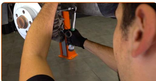
**22** Съединете куплунга към датчика на ABS. Включете куплунга на датчика за износване на спирачните накладки.
