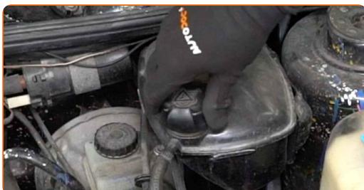
**22** Завийте капачката на резервоара за охладителна течност.
