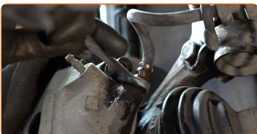
**13** Разхлабете крепежния елемент свързващ спирачната тръба със спирачния маркуч. Използвайте комбиниран гаечен ключ № 11.
