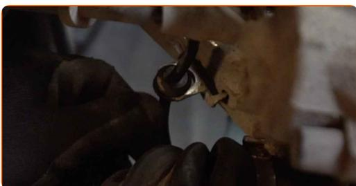
**59** Включете датчика за износване на спирачните накладки.
