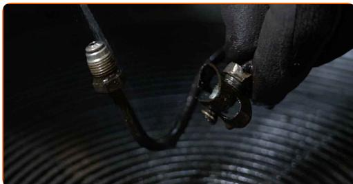
Смяна на: спирачен апарат – AUDI A6 Avant (4F5, C6). Експертите на AUTODOC препоръчват:
