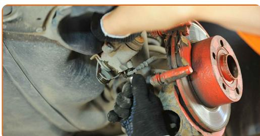
Смяна на: спирачен апарат – AUDI A4 Avant (8E5, B6).
