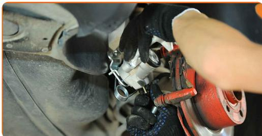
**18** Затегнете крепежните елементи на спирачния апарат. Използвайте комбиниран гаечен ключ № 15. Използвайте тръбен ключ №13. Използвайте динамометричен ключ. Затегнете я с усилие от 35 Nm.
