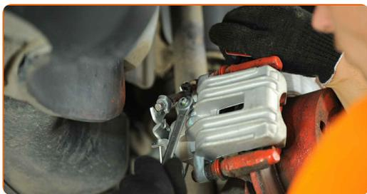
Смяна на: спирачен апарат – AUDI A4 Avant (8E5, B6). Съвет от AUTODOC:
