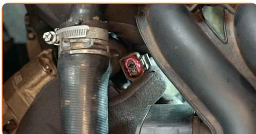
**26** Развийте крепежния елемент на захранващия кабел на алтернатора. Използвайте комбиниран гаечен ключ № 13.
