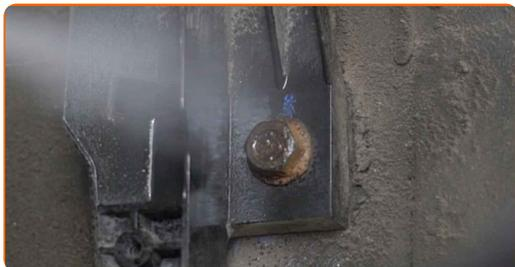
**13** Развийте крепежния елемент на адсорбатора. Използвайте тръбен ключ №13. Използвайте тресчотен ключ.
