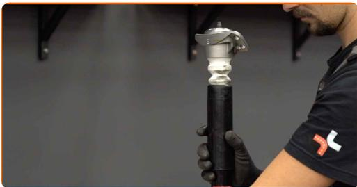
**18** Закрепете опората на амортисьора. Използвайте комбиниран гаечен ключ №14. Използвайте тръбен ключ №14. Използвайте динамометричен ключ. Затегнете я с усилие от 25 Nm.
