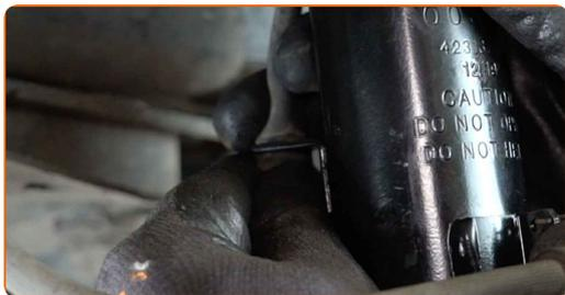
**70** Обработете крепежните елементи на макферсона. Обработете всички съединения на биалетката. Обработете крепежните елементи на задния шенкел. Използвайте медна грес.
