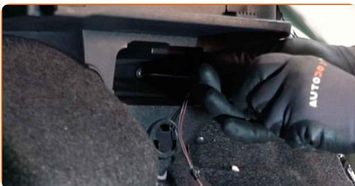
**13** Откачете страничната обшивка на багажника. Използвайте пластмасов инструмент за демонтаж на тапицERIA.
