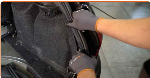
**10** Премахнете вътрешната лампа за осветление на багажника. Използвайте пластмасов инструмент за демонтаж на тапицERIA.
