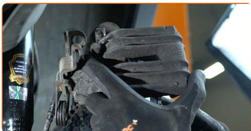
Смяна на: спирачен апарат – Audi A6 C5 Avant. Съвет от AUTODOC:
